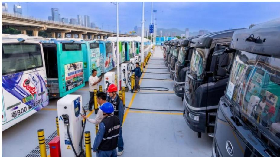
这座综合能源站配备3套英飞源的600kW大功率分体式车网互动设备，设有30个双向充放电车位。其中，包含6个液冷超充车位与24个快充车位，特
