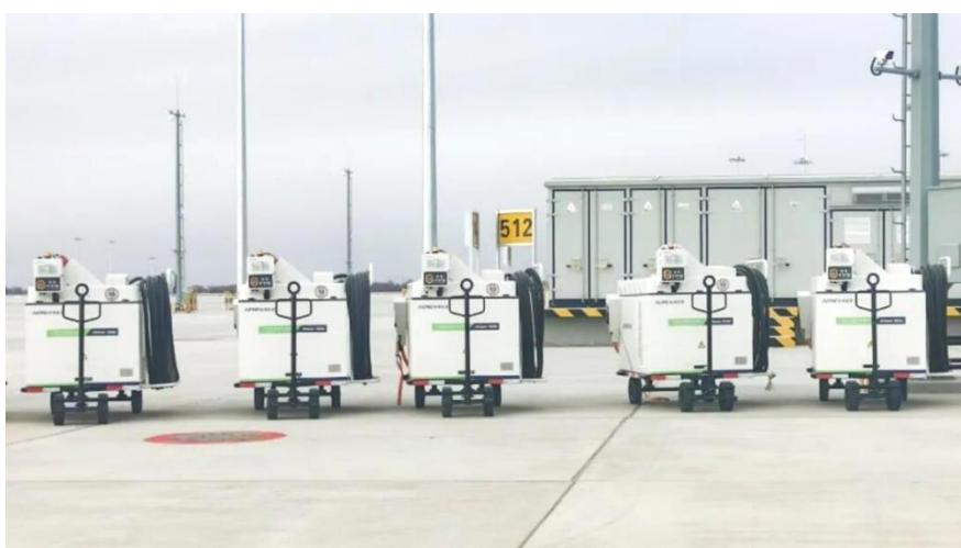
飞机电源、智能卷线装置与拖曳式底盘车为一体，远机位与近机位均可使用，其核心价值在于在飞机停靠期间提供稳定、高效的400Hz电源，从而大幅减少燃油消耗、
