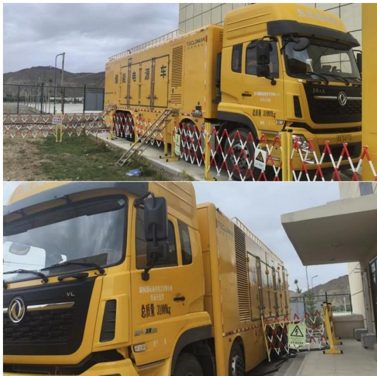
临时充电的道路救援服务，相当于一台可移动的多功能式“超级充电宝”。自研移动储能专用PCS、STS、电池模组、EMS，整车采用模块化集成设计，配备温控系统、主动消防安全系统、电缆收放系统、快速接入系统、场地照明以及直流充电桩和车顶光伏系统，独有的快速切换技术，可满足负荷供电零中断的要求。
