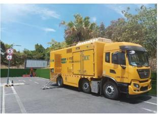
连日来,保电人员按照主办方安排部署,迅速完成接线、调试、启动并网、合闸等工作。电源车可在电网异常时,在10ms内切换到储能供电,一辆250千瓦的移动储能电源车可保电2小时。在重庆44度高温下,保电人员持续开展电力保障值守工作,监控机组状态,圆满完成了本次的保电任务。
